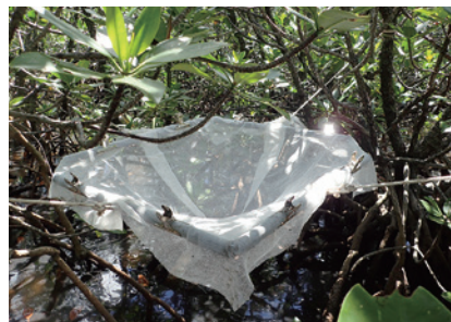
図4 マングローブ落葉の供給量測定に用いた落葉キャッチャー (縦50cm, 横50cm)。
