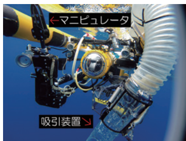
図5. 生物捕獲用のマニピュレータと吸引装置 図5". 吸引装置で捕獲したコトクラゲ
