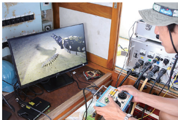
図4. 船上でのROV操作風景。水深200mでフクロアシナマコの捕獲に挑戦
