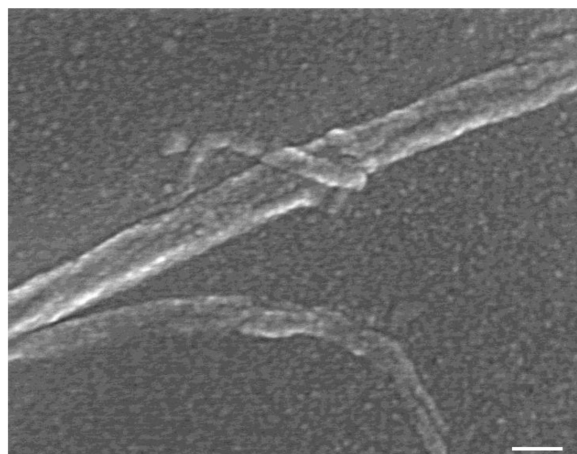
図3 組換え RTMP1の存在下では、キチン繊維上に酸化鉄粒子が形成された（左）。対照として酸化鉄形成に関係しないタンパク質（緑色蛍光タンパク質：GFP）を加えた場合には、粒子は形成されなかった（右）。
